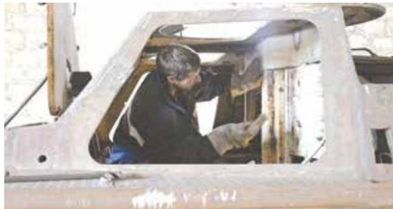
*Капитальный ремонт кузова – это максимальное усиление корпуса, часто с полной заменой деталей и узлов.*
